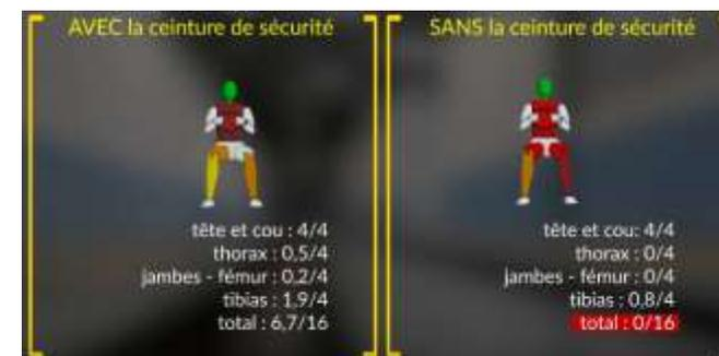
Selon les tests Euro-NCAP l'enfoncement thoracique avec ceinture est de 39 mm et sans ceinture de 51 mm.
