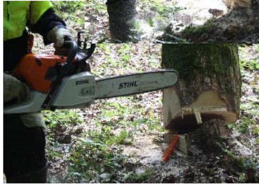
Si le diamètre de l'arbre est supérieur à la longueur du guide chaîne, effectuez une mortaise de chaque côté (2) et (3). Les deux perçages ne sont pas nécessairement au même niveau.
