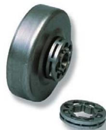
Le pignon a vocation à transmettre la puissance du moteur à la chaîne. Par conséquent, le pignon s'use et doit être remplacé selon les préconisations du constructeur (en règle générale, dès que le pignon présente une empreinte de 0,5 mm de profondeur).
