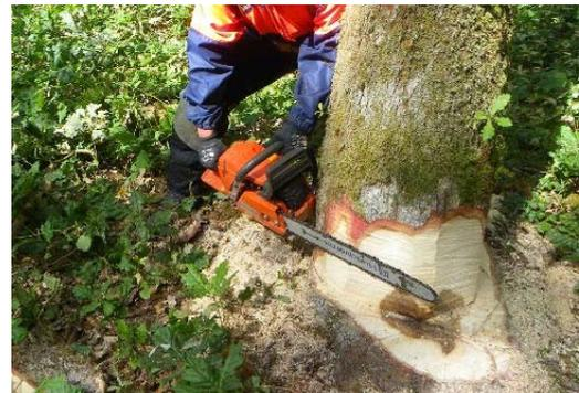
Avant de commencer, l'utilisation de la ligne de visée de la tronçonneuse permet de définir l'orientation idéale de l'entaille. Sa profondeur peut varier de 1/4 à 1/5 du diamètre de l'arbre sans jamais excéder 1/3 de ce diamètre
