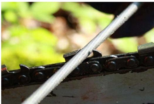
❷ La rectification du limiteur de profondeur
