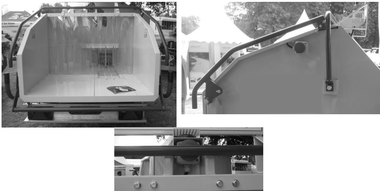
Figure 18 - Combinaison d'une barre de sécurité et d'un arrêt d'urgence
